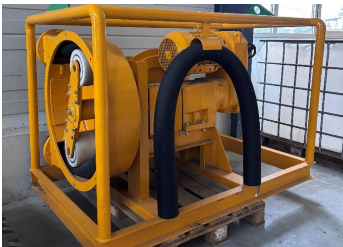
(3) Prototyp einer SP 800 Schlauchpumpe (1994/95)
