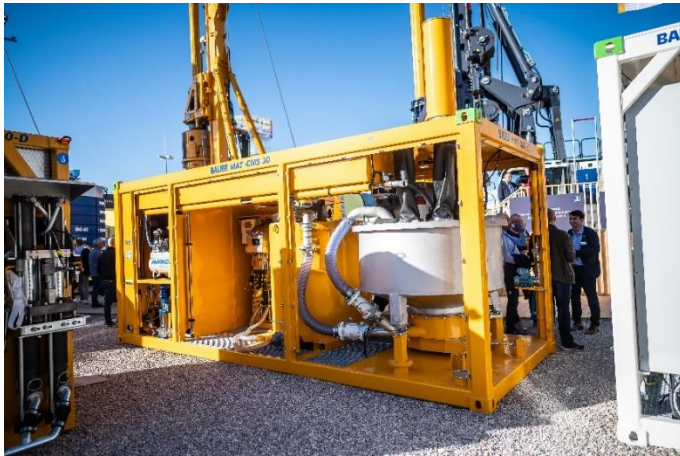
(4) Chargenmischanlage CMS 30 mit integrierter Verpresspumpe DP 101
